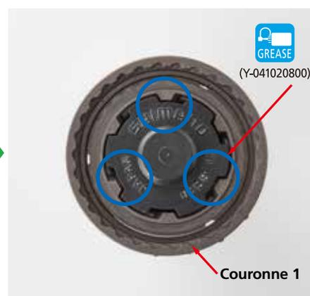
**14. Montez le ressort d'arrêt de la couronne 1 à l'aide d'un tournevis plat.**
