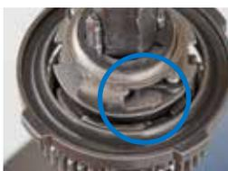
2. Montez le ressort de rappel A en plaçant la boucle la plus large vers le bas. L'anneau doit se positionner dans la rainure de l'unité d'embrayage. Veillez à ne pas monter le ressort de rappel A à l'envers.
