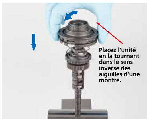
**4. Installez la cage du roulement P.**
