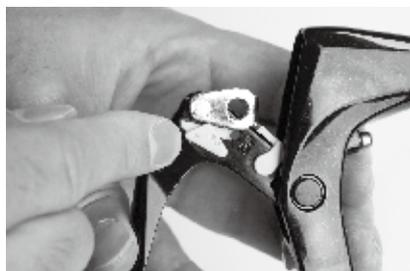
Réglez la commande de changement de mode sur la position de mode correspondant au frein installé.
