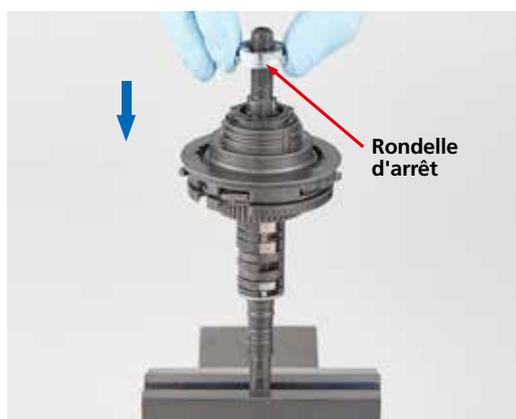
9. Lors de l'installation de la rondelle de blocage, alignez les deux dents avec les deux encoches de la rondelle d'arrêt.
