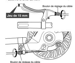
Actionner le levier de frein pour vérifier la performance de freinage, puis fixer le boulon de réglage du câble à l'aide de l'écrou de réglage du câble.
