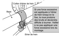
Pour poser le vis de collier, serrer le vis de collier tout en maintenant fermement l'écrou de collier avec une clé de 10 mm. Après avoir serré, vérifier que le vis de collier dépasse d'environ 2 – 3 mm de la surface de l'écrou de collier.
