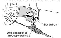
7. Après s'être assuré que l'unité du porte-gaine extérieur est insérée aussi loin que possible dans la fente de guidage de l'étrier de frein, installer le capuchon d'extrémité intérieure. Puis, installer le capuchon d'extrémité intérieure, de telle sorte qu'il ne touche pas les ailettes ou les
