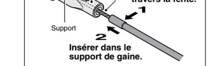
S'il est plus facile d'insérer d'abord la gaine dans le support de gaine, alors insérer d'abord la gaine dans le support de gaine, puis insérer une clé Allen de 2 mm ou un rayon #14 dans l'orifice de la poulie du raccord de cassette, puis tourner la poulie de manière que l'unité de boulon de fixation de câble se mette bien en place dans l'ouverture de la poulie.
