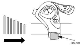
Lorsqu'on appuie une fois sur le bouton, la chaîne passe sur le plateau plus petit suivant.
