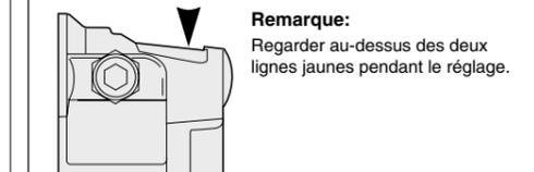
2. Tout en tournant le bras de manivelle, déplacer le levier de [1] à [1] puis de [1] vers [3] à nouveau deux à trois fois pour vérifier le changement des vitesses. Placer le levier sur [2] puis vérifier que la ligne rouge sur la barre de liaison est alignée avec l'extrémité de l'axe de moyeu.
