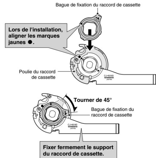
**Installation du frein Inter-M sur le corps de moyeu**
