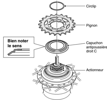
**Montage du raccord de cassette sur le moyeu**
