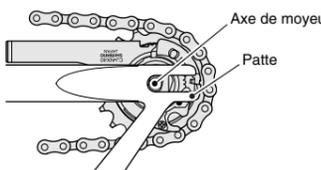
2. Placer les rondelles fixes sur les côtés droit et gauche de l'axe de moyeu. A ce moment, tourner le raccord de cassette de manière que les saillies des rondelles fixes se mettent en place dans les rainures des pattes. On pourra alors monter le raccord de cassette de manière qu'il soit presque parallèle à la base.
