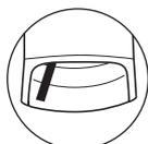
**3.** Posez l'unité d'indicateur en engageant d'abord le crochet, puis fixez-la en serrant les quatre vis de fixation de l'indicateur.
