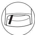
3. Posez l'unité d'indicateur en engageant d'abord le crochet, puis fixez-la en serrant les trois vis de fixation d'indicateur. Tornevis n° 2
