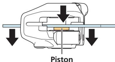
5. Installez les plaquettes de frein et la cale de plaquette (orange) dans l'étrier.
