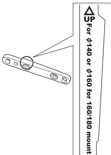
3. Installez provisoirement le support de montage sur le cadre afin qu'il puisse bouger à gauche et à droite.
