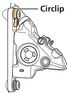
► **Installation avec un support de montage : si vous utilisez un disque de frein de Ø 160 mm (fixation 140/160 mm) ou un disque de frein de Ø 180 mm (fixation 160/180 mm)**
