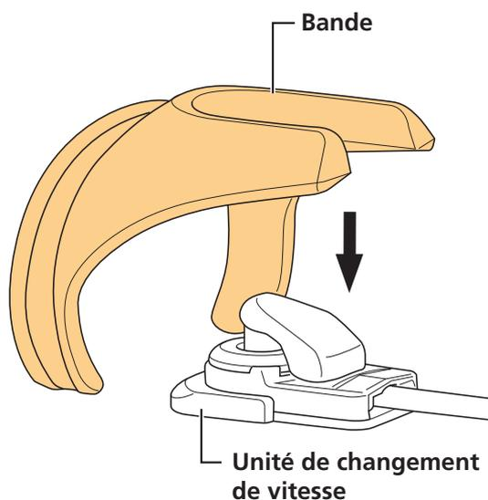
**2. Placez la feuille en caoutchouc en position d'installation et installez la manette de changement de vitesse satellite par-dessus.**
