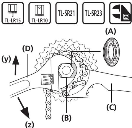
Lors de l'installation des pignons HG, utilisez l'outil d'origine Shimano TL-LR15/LR10 pour serrer la bague de blocage. Lors du remplacement des pignons HG, utilisez les outils d'origine Shimano TL-LR15/LR10 et TL-SR21/23 pour déposer la bague de blocage.
