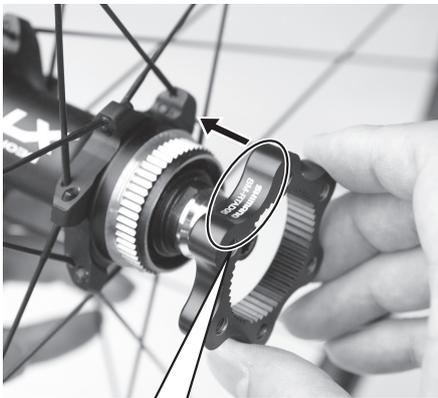
Installez l'adaptateur de disque de frein à disque sur le moyeu.
