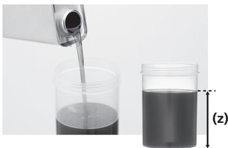
Remplissez la bouteille d'huile d'entretien jusqu'à une hauteur de 95 mm.
