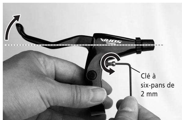
Le fait de tourner dans le sens inverse des aiguilles d'une montre agrandit la largeur.
