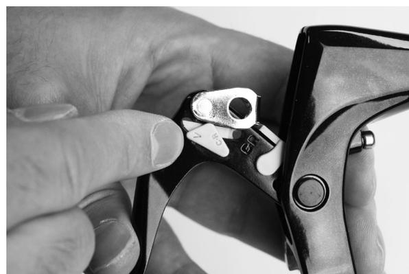
2. Alignez le changement de mode sur la position du frein installé.
