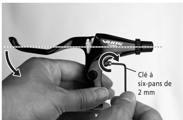
Le fait de tourner dans le sens des aiguilles d'une montre réduit la largeur.
