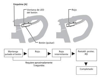
Cuando se enciende el LED rojo del empalme [A], el cambio trasero no cambia. Pulse el botón hasta que el LED rojo se apague.
