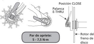
Si se ofrecen instrucciones sobre la posición de apriete de la palanca E-THRU en las Instrucciones de servicio, sígalas para apretar.
