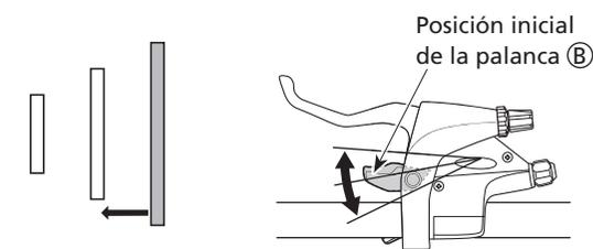
"Se puede efectuar el cambio de marchas presionando o tirando de la palanca."
