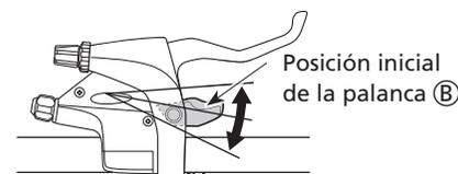
"Se puede efectuar el cambio de marchas presionando o tirando de la palanca."
