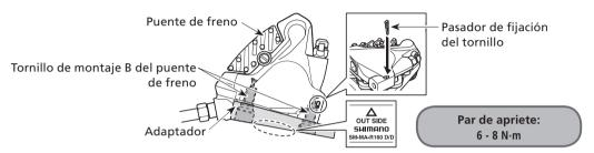
2. Introduzca el tornillo de montaje C del puente del freno en la zona de montaje del cuadro y asegúrese de que la longitud de la parte saliente sea de 13 mm.
