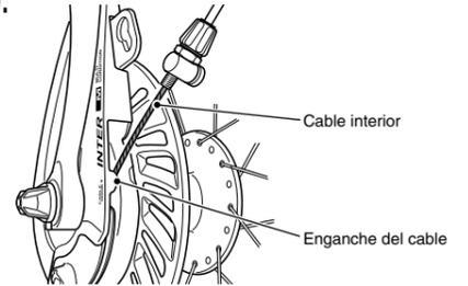
7. Inserte el soporte de la envoltura exterior en el orificio del brazo del freno y deslícelo sobre la sección más baja del orificio.
