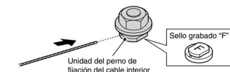
3. Coloque los componentes como se indica en la siguiente ilustración y apriete la tuerca de fijación del cable interior. Utilice la TL-IM21 (herramienta de fijación del cable interior) para apretar la tuerca de fijación del cable interior tal y como se indica en la Fig. 1. Tras apretar, compruebe que las orientaciones de la tuerca de fijación del cable interior y el cable interior sean las correctas, tal y como se indica en la Fig. 2.
