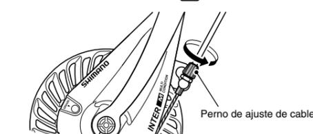
3. Después de empujar la palanca de freno para verificar el rendimiento de los frenos, asegure el perno de ajuste de cable con la tuerca de ajuste de cable.
