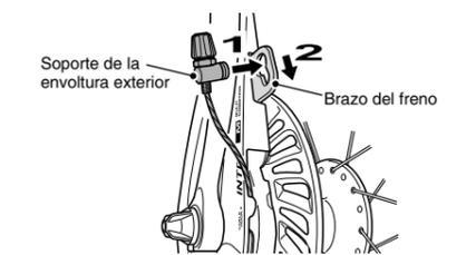
8. Después de comprobar que el soporte de la envoltura del cable está insertada firmemente en la parte posterior del orificio del brazo del freno, ajuste la tapa del extremo del cable de manera que no toque las aletas ni los radios.
