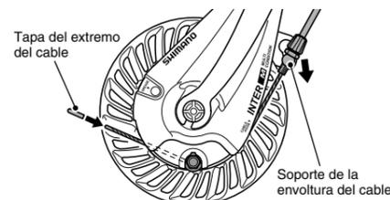
9. Gire el perno de ajuste del cable para tensar el cable interno.
