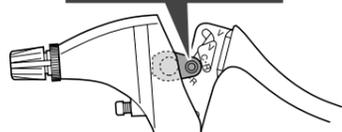
La C indica la posición de modo para compatibilizar con los frenos cantilever. La R indica la posición de modo para compatibilizar con los frenos de rodillo.
