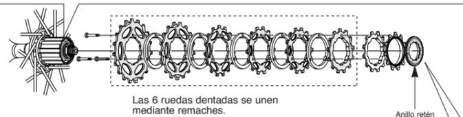
Al instalar las ruedas dentadas HG, usar la herramienta especial (TL-LR15) para apretar el anillo retén.
