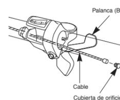
Instalar la cubierta de orificio girándola tal como se indica en la figura hasta que haga tope. No girarla más allá de esto, de lo contrario se podría dañar la rosca del tornillo.
