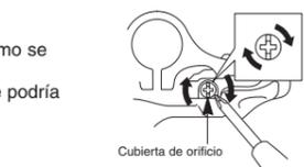
Conectar el cable al desviador de cambio trasero, después tirar del cable eliminando la flojedad, asegurarlo al desviador de cambio trasero, como se indica en la figura.
