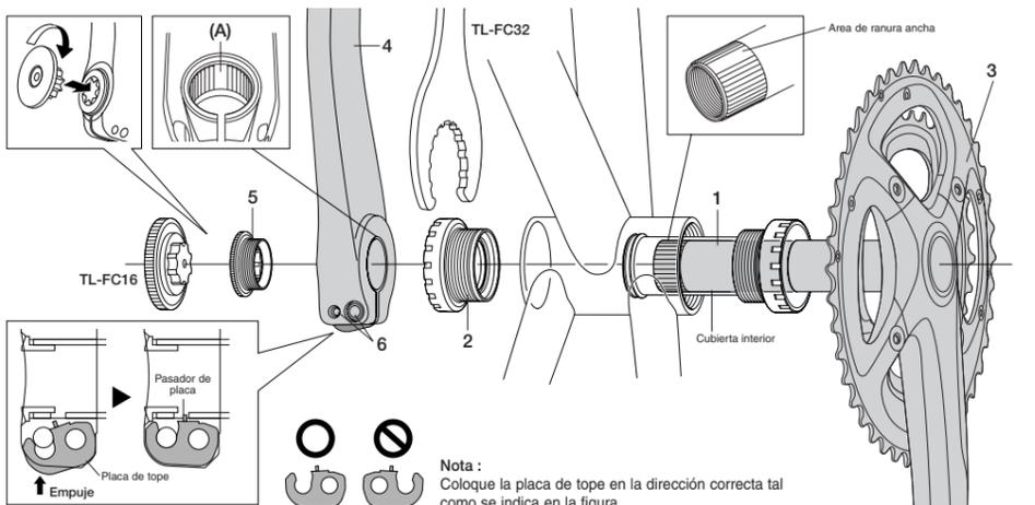
Nota : Coloque la placa de tope en la dirección correcta tal como se indica en la figura.
