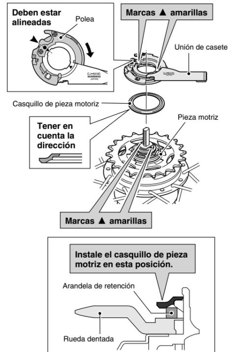
2. Asegurar la unión de casete al cubo con un anillo de fijación de unión de casete. Al instalar el anillo de fijación de unión de casete, alinear la marca amarilla ● con la marca amarilla ● de la polea de unión de casete, y luego girar el anillo de fijación de unión de casete 45° hacia la derecha.
