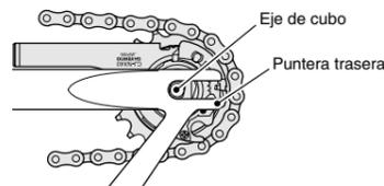
2. Colocar las arandelas de seguridad en los lados derecho e izquierdo del eje de cubo. En este momento, girar la unión de casete de manera que las proyecciones de las arandelas de seguridad encajen en las ranuras de las punteras traseras. Si se realiza eso, la unión de casete puede ser instalada de manera que quede casi paralela a los tirantes traseros inferiores.
