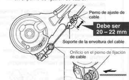
6. Verificar que ambos extremos de la envoltura de cable están bien insertados en los pernos de ajuste de cable de la palanca de cambio y el brazo de freno.
