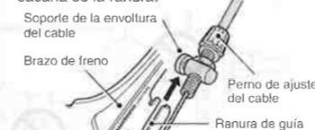
Para instalar otra vez el cable del freno, realizar el procedimiento anterior a la inversa.
