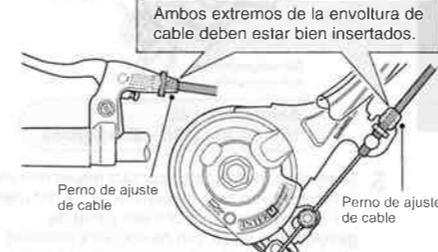
7. Empujar la unión hacia atrás hasta que haga tope. Luego, tirando del cable para tensarlo bien, apretar la tuerca de fijación de cable.
