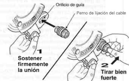
Nota: Mirando desde atrás de la unión, verificar que el perno de fijación del cable se encuentra firme en la posición indicada en la figura anterior.
