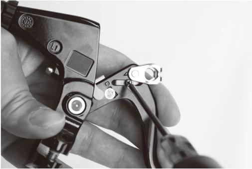
2. Ajuste el interruptor de modo con la posición de modo para el freno instalado.
