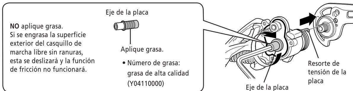
**Asegúrese de instalar el estabilizador del conmutador. Si intenta hacer funcionar el conmutador de palanca sin el estabilizador del conmutador instalado, se dañará el producto.**
