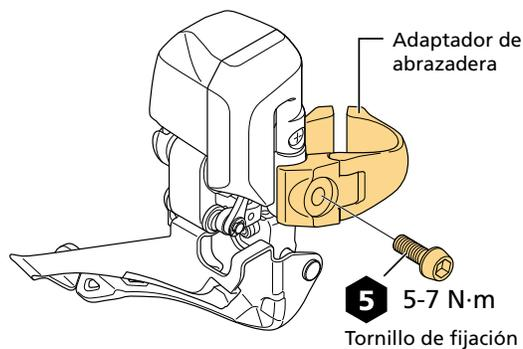
2. **Apriete el tornillo de sujeción hasta que toque el adaptador de abrazadera.**
