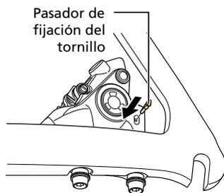
Instalación con un tornillo de fijación C/C2 de la pinza: cuando se utiliza un disco de freno de  $\varnothing$  160 mm (soporte de 140/160 mm) o un disco de freno de  $\varnothing$  180 mm (soporte de 160/180 mm)
