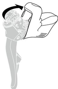
2. **Abra el soporte de la batería con un destornillador y retire la pila de moneda antigua empujando su punta hacia abajo.**
