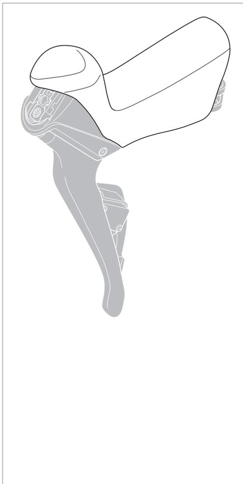
Encaje las secciones sobresalientes de la tapa del soporte en las ranuras de la unidad del soporte.
