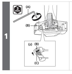
Gire el tornillo de ajuste del muelle para ajustar la tensión del muelle en el punto más débil.
