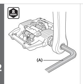
Utilice una llave hexagonal de 8 mm para instalar los pedales en las bielas.
