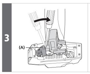
Utilice un instrumento romo para ajustar la lengüeta en el otro extremo del reflector en el anclaje del pedal. (A) Anclaje
