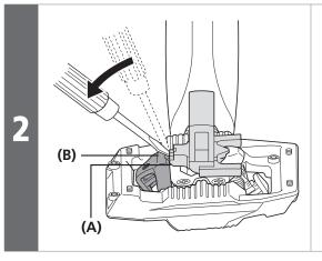
Utilice un instrumento romo para sacar la lengüeta del reflector del anclaje del pedal. (A) Lengüeta
