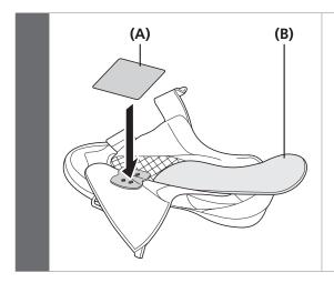
Retire la plantilla y fije la junta impermeable.
