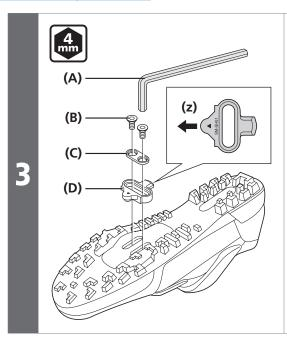
Coloque la cala con el adaptador de cala sobre la suela de la zapatilla y apriételos temporalmente con los tornillos de montaje de la cala. Las calas son compatibles tanto con pedales izquierdos como derechos.
