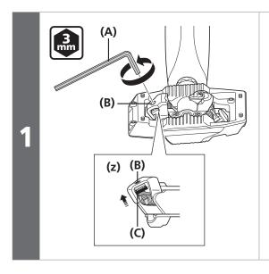
Gire el tornillo de ajuste del muelle para ajustar la tensión del muelle en el punto más débil.
