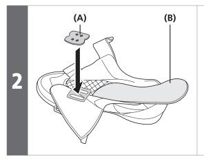
Extraiga la plantilla y coloque una tuerca de cala sobre los orificios ovalados.
