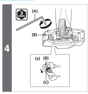
Gire el tornillo de ajuste del muelle para ajustar la tensión del muelle en el punto más fuerte.
