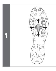
La cala tiene un intervalo de ajuste de 20 mm de delante a atrás y de 5 mm de derecha a izquierda.
