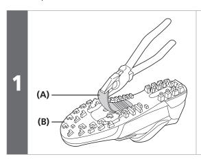
Con un par de alicates o una herramienta similar, tire de la cubierta de goma para exponer los orificios de montaje de la cala.
