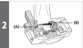
Inserte la lengüeta del reflector en la tapa del cuerpo del pedal.
