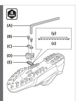
Coloque el separador de cala, seguido de la cala, y a continuación el adaptador de cala sobre la suela de la zapatilla y apriételos temporalmente con los tornillos de fijación de la cala.
