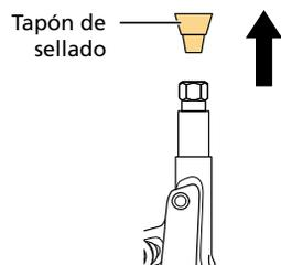
**4. Inserte el latiguillo de freno en el orificio de conexión de latiguillo de freno correspondiente.**
