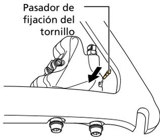
**Instalación con un tornillo de fijación C/C2 de la pinza: cuando se utiliza un disco de freno de Ø160 mm (soporte de 140/160 mm) o un disco de freno de Ø180 mm (soporte de 160/180 mm)**
