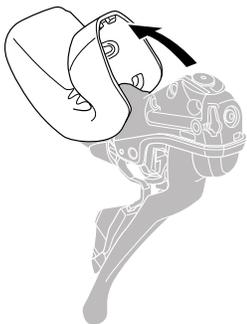
6. Coloque la maneta en una posición en la que la superficie superior del tornillo de purga esté paralela al suelo.
