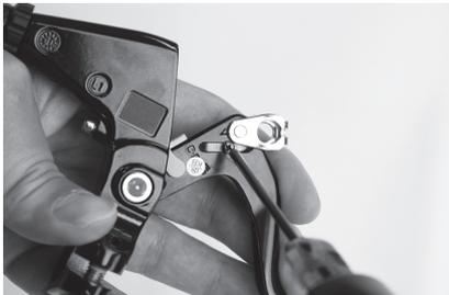
Utilice un destornillador de estrella [n.º 1] para aflojar el tornillo.
