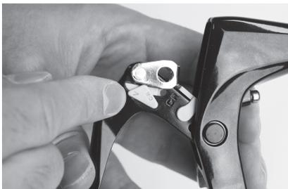
Ajuste el interruptor de modo con la posición de modo para el freno instalado.
