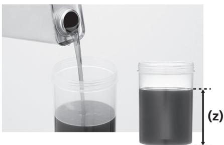
Llene el depósito con aceite de mantenimiento hasta una altura de 95 mm.
