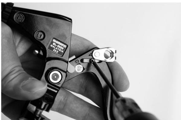
1. Utilice un destornillador N.º 1 para aflojar el tornillo.
