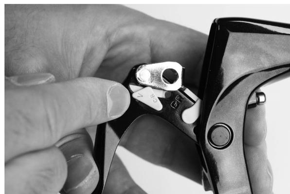
2. Alinee el interruptor de modo con la posición del freno instalado.
