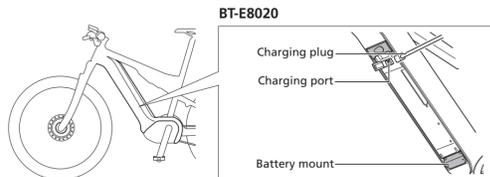
BT-EN805 / BT-EN805-L / BT-EN806 / BT-E8035 / BT-E8035-L / BT-E8036
