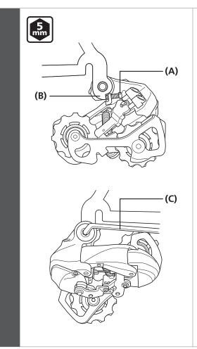
Install the rear derailleur to the frame.
