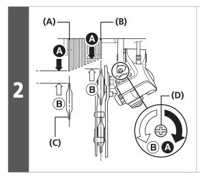
Adjust the B-tension adjust bolt.
