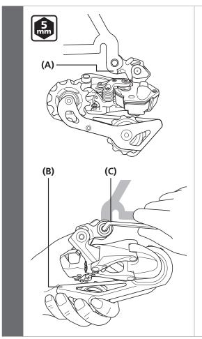
Install the rear derailleur to the frame.
