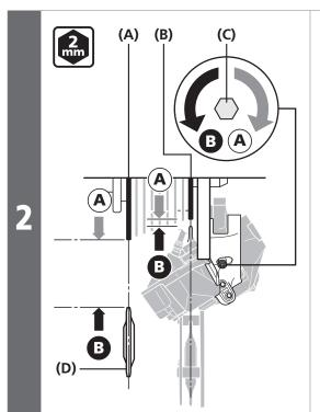
Adjust the end adjust bolt.
