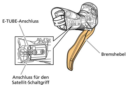
\* Der E-TUBE-Anschluss und der Anschluss für den Satellit-Schaltgriff können nicht verwendet werden. Es kann kein Blindstecker angebracht werden.
