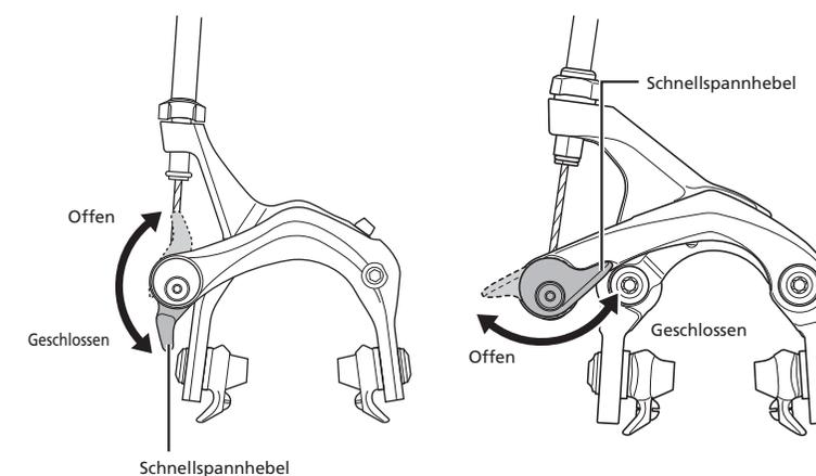
Richten Sie bei Modellen, die eine Markierung für die geschlossene Position (CLOSE) auf dem Schnellspannhebel und auf der Bremssattelseite haben, die beiden Markierungen aufeinander aus. Achten Sie dabei darauf, dass Sie ein Klicken hören.
