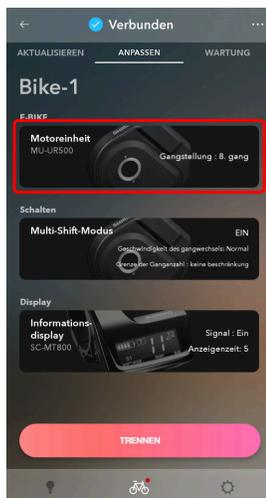
2. Wählen Sie die Anzahl der Gänge in der Getriebenabe, an welche die Motoreinheit montiert wurde.
