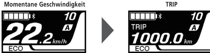
Die Fahrtdaten wechseln jedes Mal, wenn <F> gedrückt wird, in folgender Reihenfolge.
