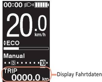
Die Fahrtdaten wechseln jedes Mal, wenn <F> gedrückt wird, in folgender Reihenfolge.
