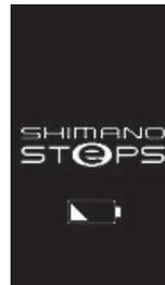
\* Der Ladezustand des im Fahrradcomputer eingebauten Akkus ist zu niedrig.
