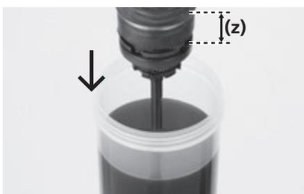
Tauchen Sie die interne Einheit von links ins Öl, sodass das Öl bis zur Getriebeeinheit 1 reicht (siehe Abbildung).
