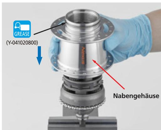
**12. Setzen Sie den Kuglkäfig auf das Nabengehäuse.**
