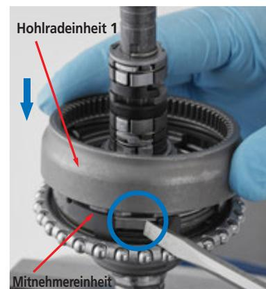
**3. Montieren Sie die Trägereinheit 1 und drehen Sie sie dabei leicht nach links und rechts.**
