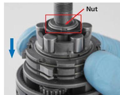
10. Setzen Sie die Bremsschuheinheit auf.
