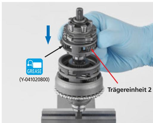
9. Drücken Sie die Trägereinheit von oben herunter, sodass die Nut zu sehen ist, in die der Begrenzungsring eingesetzt wird; und bringen Sie dann den Begrenzungsring an.
