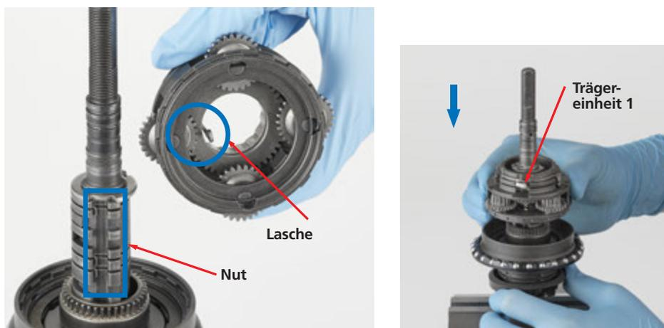
Achten Sie bei der Montage darauf, dass Sie die Lasche der Trägereinheit 1 in die Nut der Achseinheit einsetzen.
