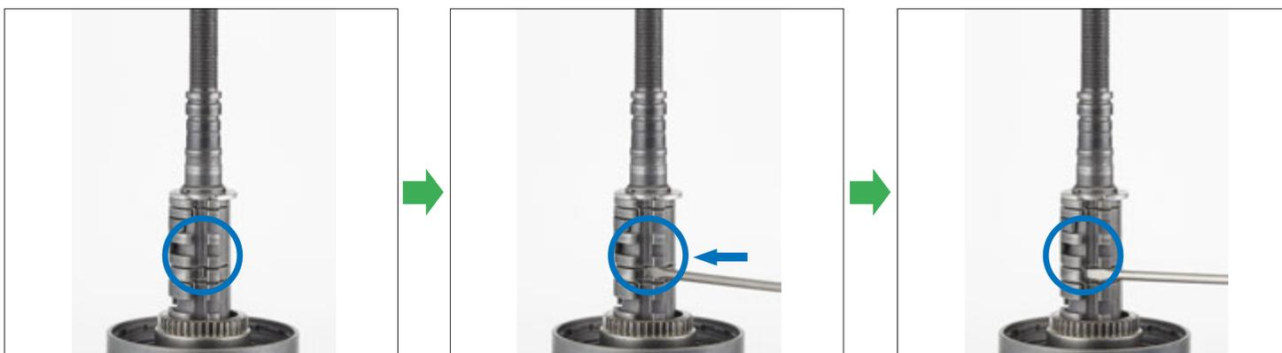
(2) Setzen Sie alle Teile bis zum Hohlrad 1 auf.
