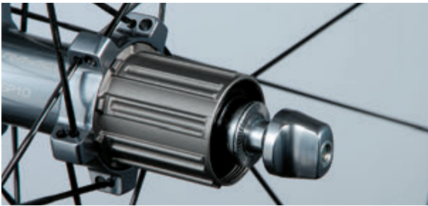
Labyrinth- und Schleifdichtung (Rennrad)
