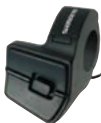
SW-E6010-L Linke Schaltereinheit für Unterstützungsmodus
