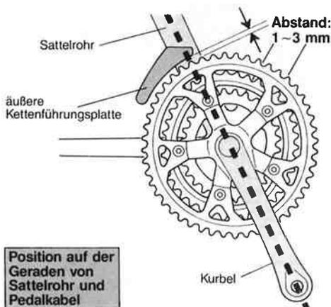
Position auf der Geraden von Sattelrohr und Pedalkurbel
