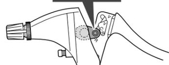
Mit C wird die Betriebsart für die Kompatibilität mit Mittenzugbremsen bezeichnet. Mit R wird die Betriebsart für die Kompatibilität mit Klemmrollenbremsen bezeichnet.
