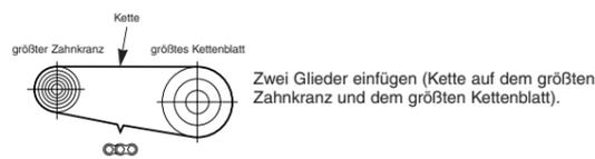
**Einbau des Schalthebels (SL-M780-R)**
