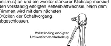
Ein erster Klickstop zeigt beim Umschalten mit dem Hebel b den Beginn des Trimmens (Geräuschverhütungsmechanismus) an und ein zweiter stärkerer Klickstop markiert den vollständig erfolgten Kettenblattwechsel. Nach dem Trimmen wird mit dem nächsten Drücken der Schaltvorgang abgeschlossen.
