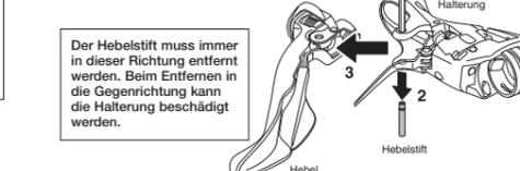
**Einbau der Halterung und des Hebels**
